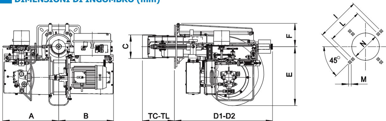
D2= ingombro a bruciatore arretrato in posizione di manutenzione.
