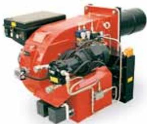
Bruciatori di olio combustibile a tre stadi, ventilatore ad alta prevalenza, testa di combustione con regolazione ad alto rendimento ed elevata stabilità di fiamma, completo di elettroattuatori per l'apertura delle serrande aria comburente, adeguati per nafte fino a 20°C a 50°C e per nafte BTZ.
