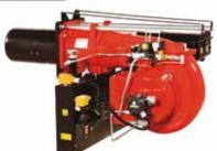
Bruciatori di nafta a 2 stadi, ventilatore ad alta prevalenza, testa di combustione con regolazione ad alto rendimento ed elevata stabilità di fiamma, sistema idraulico di regolazione aria comburente sui due regimi di fiamma.
