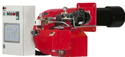
Bruciatori di gasolio bistadio progressivi (hi-low flame) o modulanti (PID fully modulating) con l'aggiunta del sistema opzionale kit modulazione e sonda. Ventilatore ad alta prevalenza, testa di combustione con regolazione ad alto rendimento ed elevata stabilità di fiamma.
