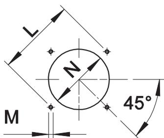
La taille de la plaque porte-brûleur sur la porte de la chaudière (trous fileté et goujons) doit être conforme au dessin.
