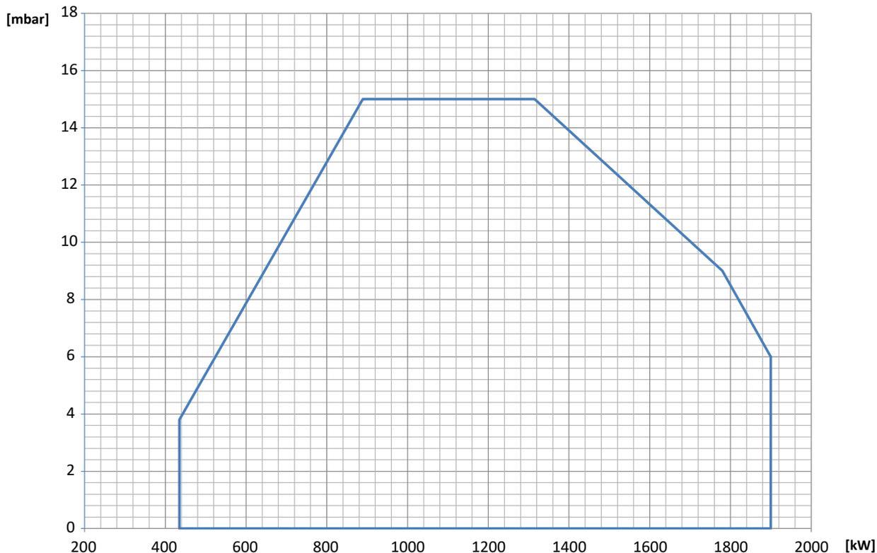
Fig. X = Potenza termica Y = Pressione in camera di combustione
