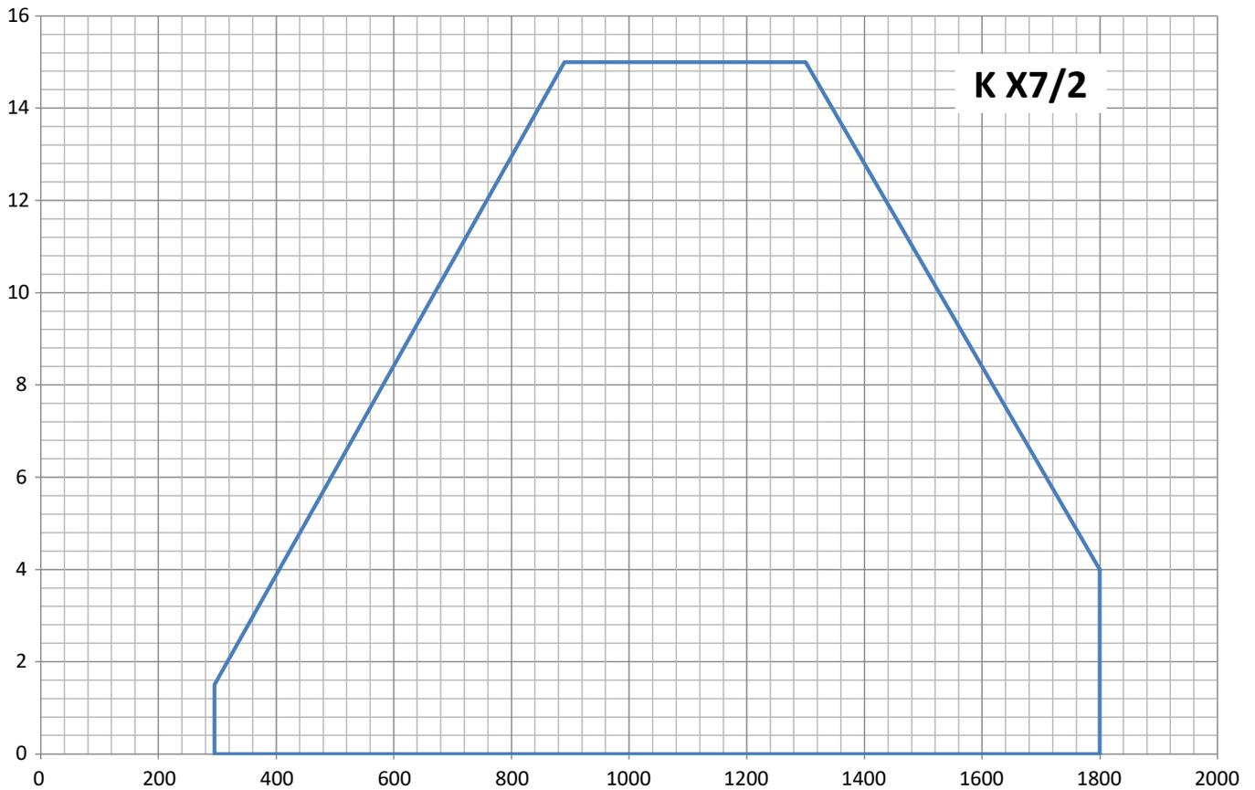
Fig. X = Potencia térmica [kW] Y = Presión en la cámara de combustión [mbar]
