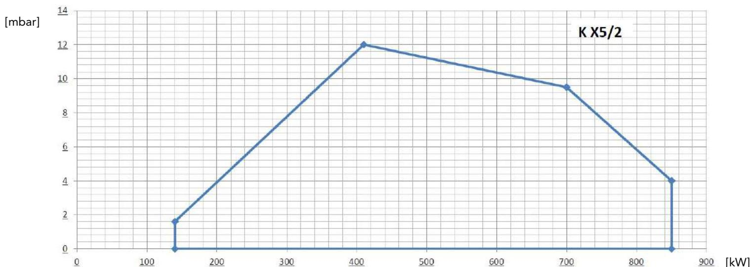
**Fig. 2 X = Puissance thermique Y = Pression en chambre de combustion**
