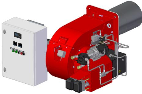
Brûleurs de fuel lourde 3 allures , ventilateur à la haute pressurisation, tête de combustion avec régulation à haut rendement et stabilité élevée de flamme, complet de servomoteurs pour l'ouverture des rideaux air, aptes pour fioul lourde jusqu'à 20°C à 50°C et pour fioul lourde BTZ.
