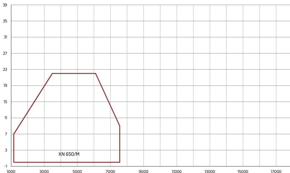
Fig. 3 X = Puissance thermique Y = Pression en chambre de combustion
