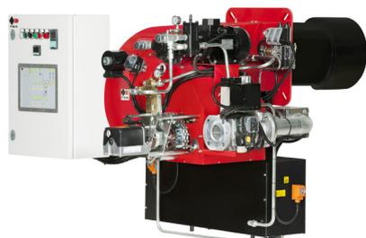
Brûleurs mixtes gaz/fioul lourd 2 allures progressives (hi-low flame) ou modulantes (PID fully modulating) avec l'addition de système optionnel modulation et sonde (pour le contrôle de température ou pression).
