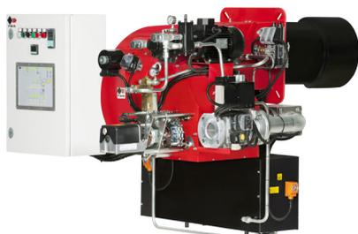
Bruciatori misti gas/olio combustibile (nafta) bistadio progressivo (hi-low flame) o modulanti (PID fully modulating) con l'aggiunta degli accessori opzionali kit di modulazione (digitale) e sonda (per controllo di temperatura o pressione). Adatti al funzionamento anche con combustibili BTZ (basso tenore di zolfo). Ventilatore ad alta prevalenza, testa di combustione con regolazione ad alto rendimento ed elevata stabilità di fiamma, completi di fiamma pilota di accensione gas.
