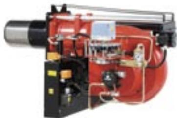
Brûleurs pour fioul lourde 2 allures progressif ou complètement modulant avec l'addition de l'équipement facultatif de modulation et sonde (de température ou pression). Ventilateur à haute pressurisation, tête de combustion haute rendement et haute stabilité de flamme, servomoteur pour régulation balancé d'air et fioul.
