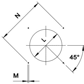
Las dimensiones de la brida de fijación del quemador (orificios roscados o para espárragos) deben coincidir con el dibujo.
