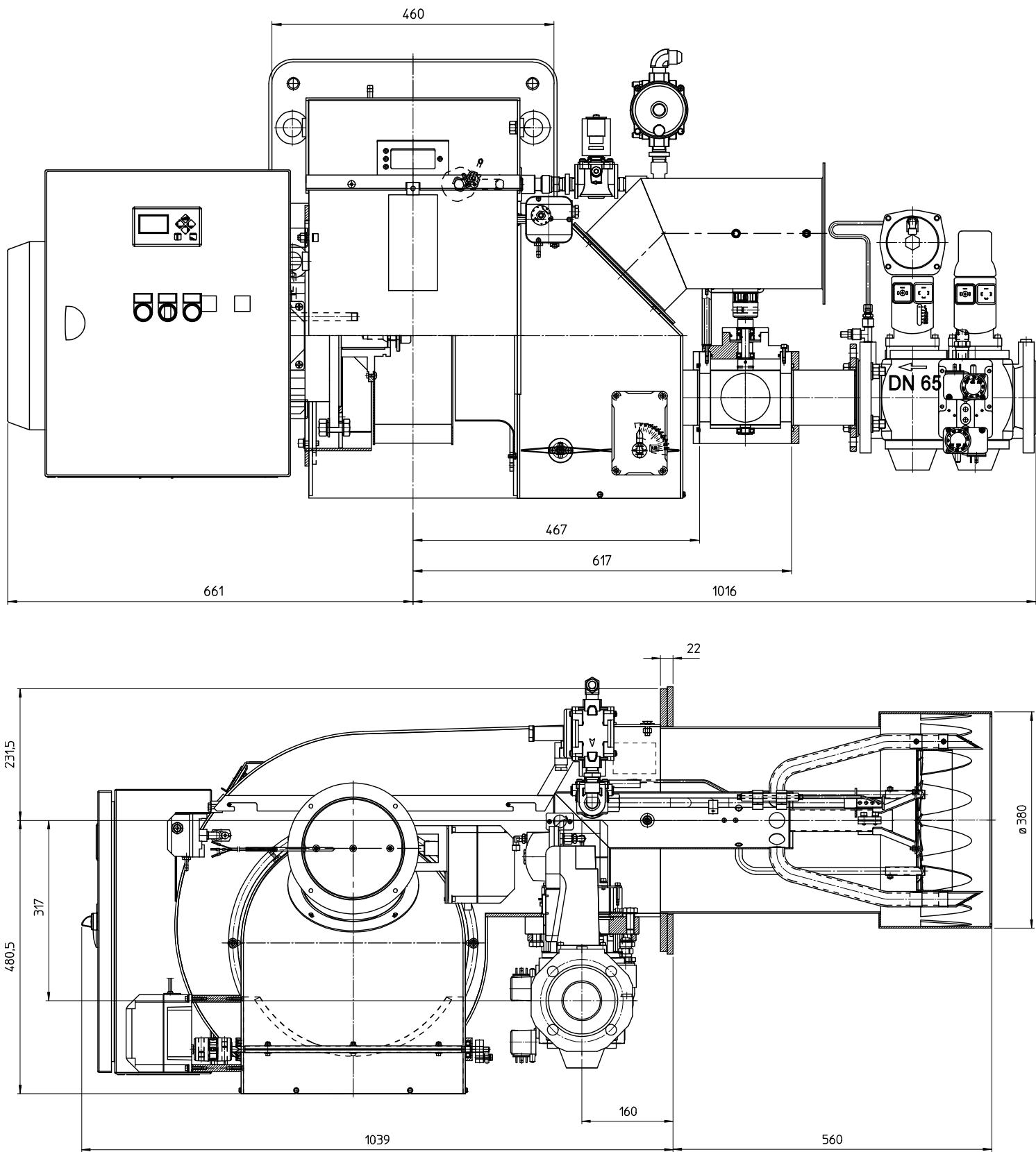
Fig. 13 Dimensions GAS P550/M-LX-FGR-EL
