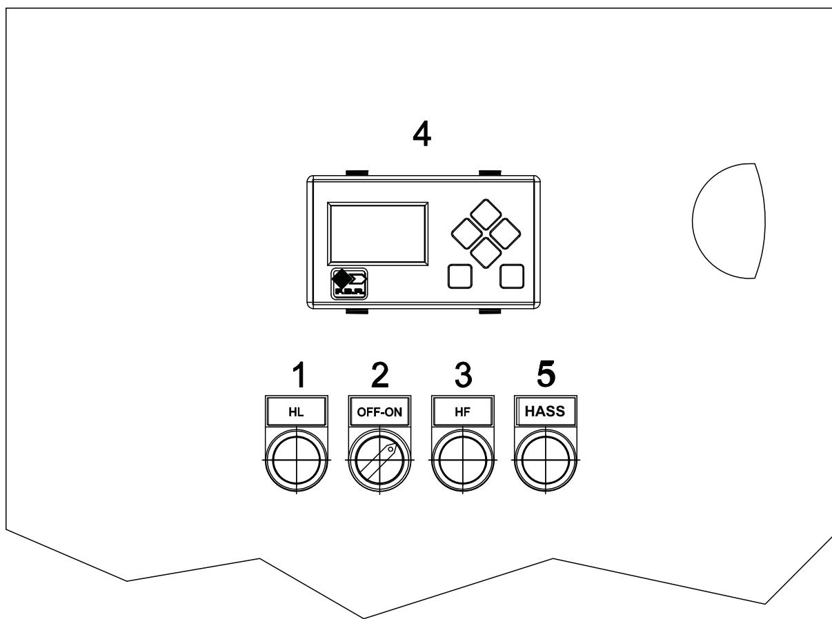
**Fig. 19** Burner control panel GAS P1800/M-LX-FGR-EL
