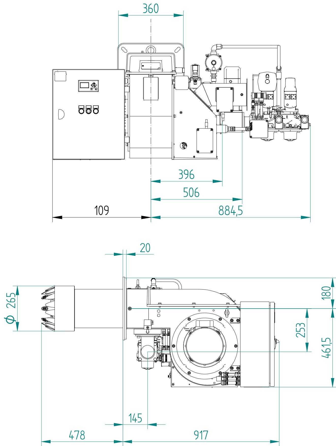
Fig. 8 Dimensions GAS P190/M-LX-FGR-EL
