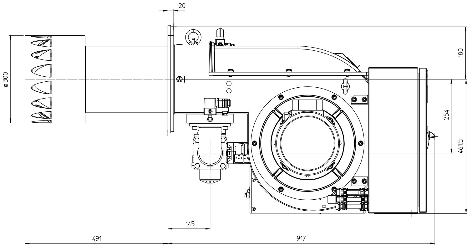
Fig. 10 Dimensions GAS P300/M-LX-FGR-EL
