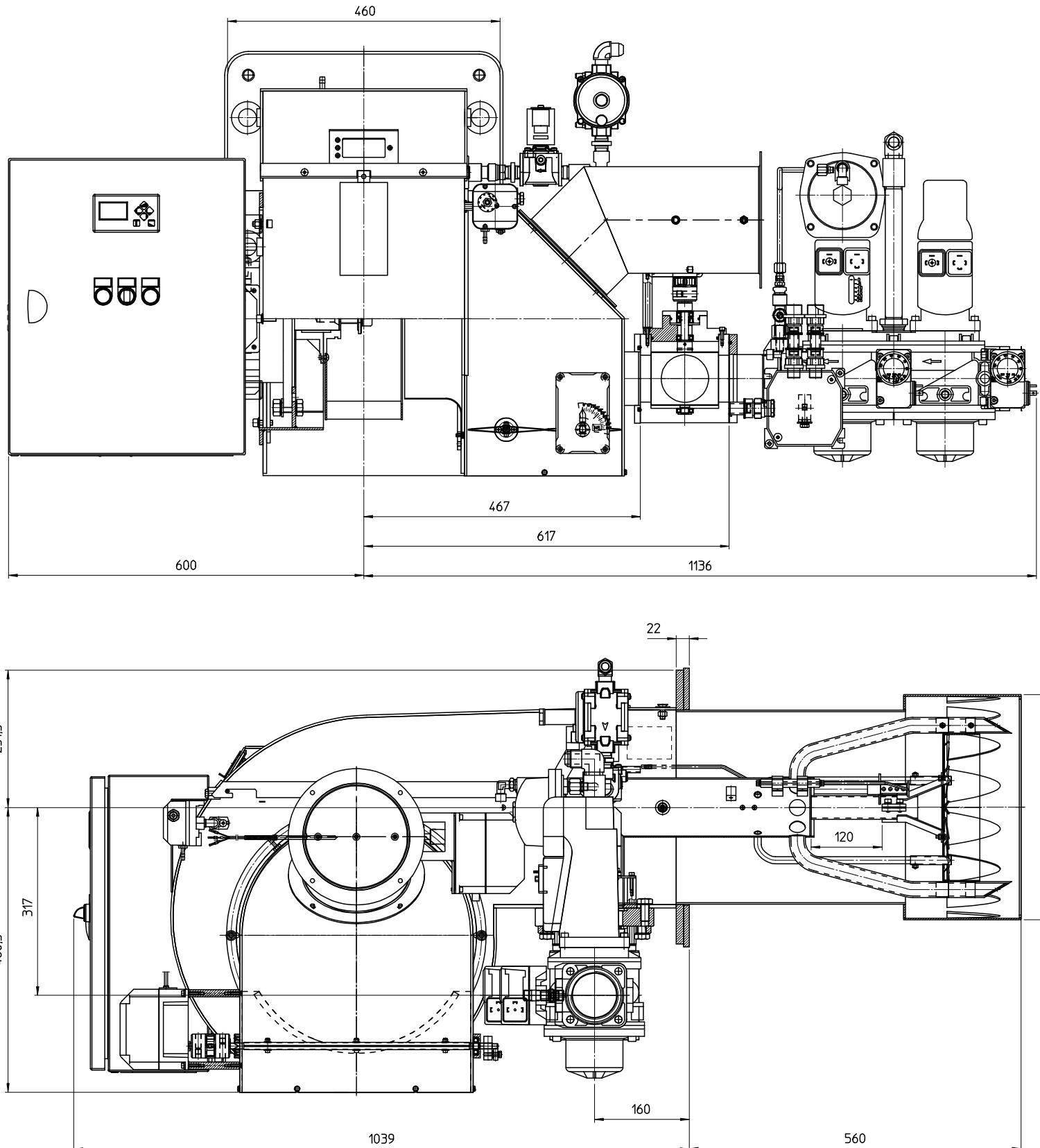
Fig. 11 Dimensions GAS P350/M-LX-FGR-EL
