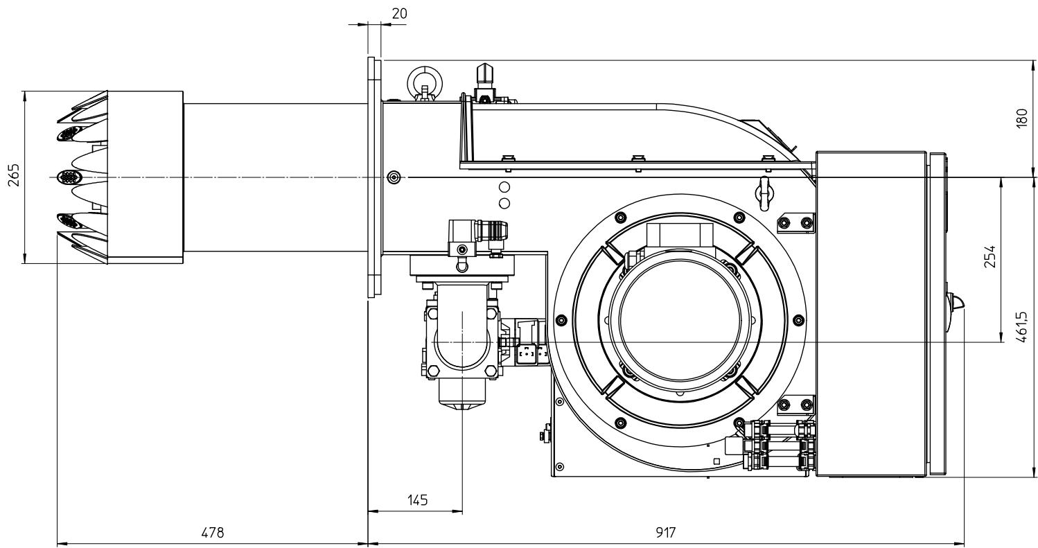
**Fig. 9** Dimensions GAS P250/M-LX-FGR-EL
