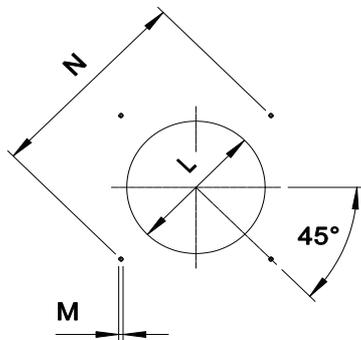
El tamaño de la brida de acoplamiento caldera-quemador debe ser según dibujo.
