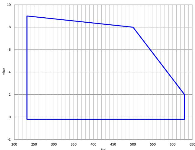
**Fig. 1** X = Мощность Y = Соппротивление камеры сгорания
