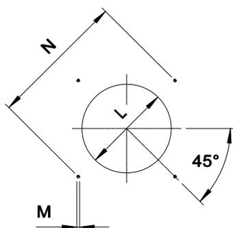
**Fig. 3 Фланец для установки горелки**
