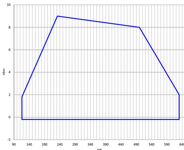
Fig. 2 X = Мощность Y = Сопротивление камеры сгорания
