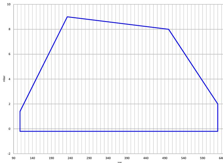
Fig. 2 X = Caudal Y = Presión en la cámara de combustión
