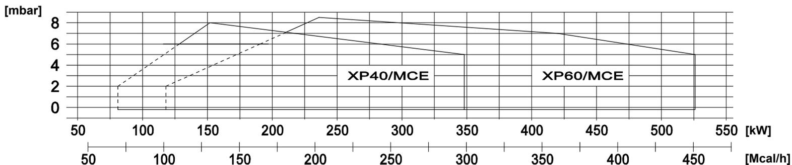
**Fig. 2** X = Potenza termica Y = Pressione in camera di combustione
