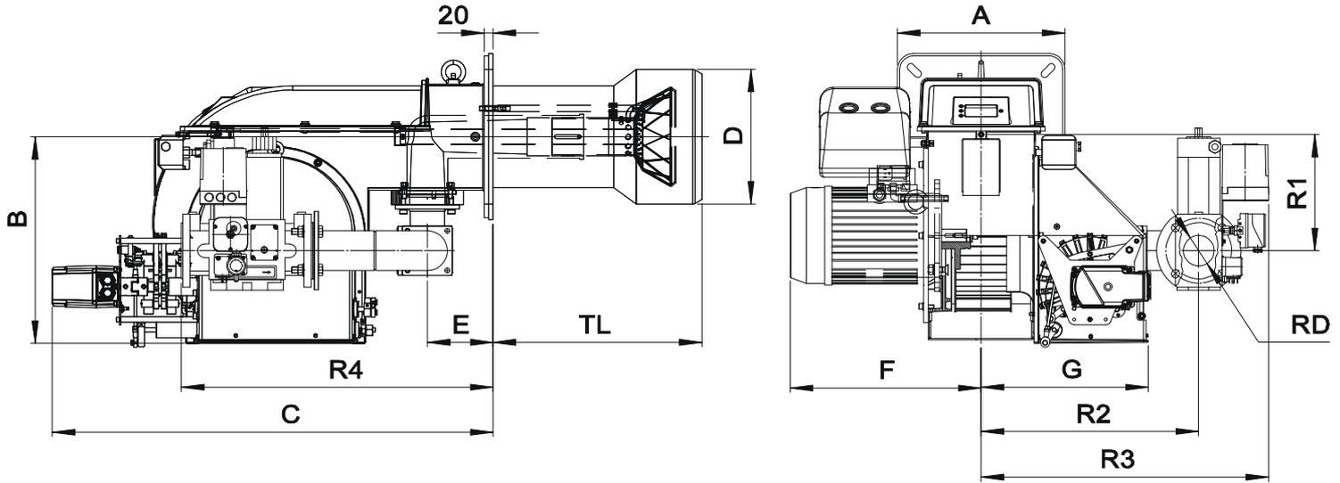
Fig. 4 Medidas GAS P190/M CE-LX - GAS P250/M CE-LX
