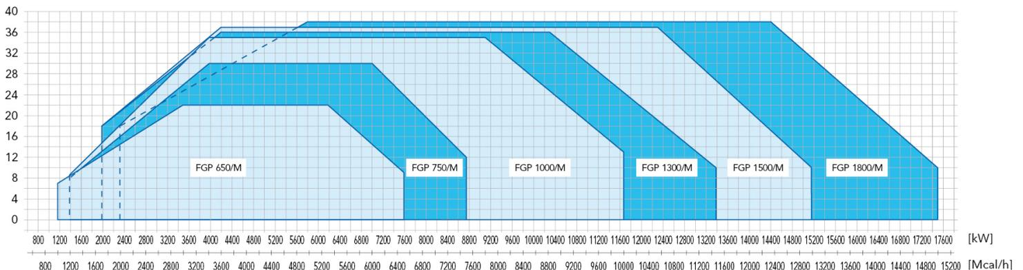
Fig. 2 X = Potenza termica Y = Pressione in camera di combustione
