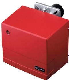
Bruciatori di gasolio bistadio a salto di pressione, con scocca in alluminio, cofano di protezione con lastra fonoassorbente, testa di combustione con regolazione micrometrica ad alto rendimento ed elevata stabilità di fiamma, sistema idraulico di regolazione aria comburente sui due regimi di fiamma.
