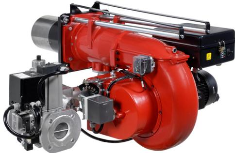
Brûleurs GAZ deux flammes progressifs (hi-low flame) ou modulant (PID fully modulating) avec l'addition du système optionnel kit modulation et sonde. Ventilateur à haute pressurisation, tête de combustion avec régulation à haut rendement et stabilité élevée de flamme.
