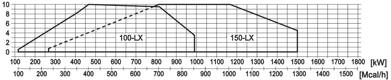
Fig. 1 X = Puissance (kg/h - Mcal/h) Y = Pression en chambre de combustion (mbar)
