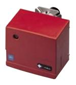
Brûleurs fioul deux allures au saut de pression, avec coque en aluminium, coffre de protection avec plaque insonore, tête de combustion avec régulation micrométrique à haut rendement et stabilité élevée de flamme, dispositif hydraulique de régulation air comburant sur les deux régimes de flamme.
