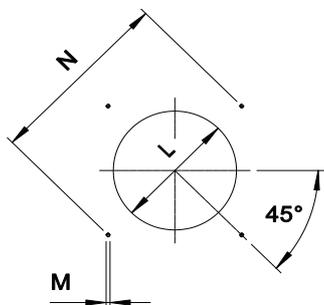
La taille de la plaque porte-brûleur sur la porte de la chaudière doit être conforme au dessin.
