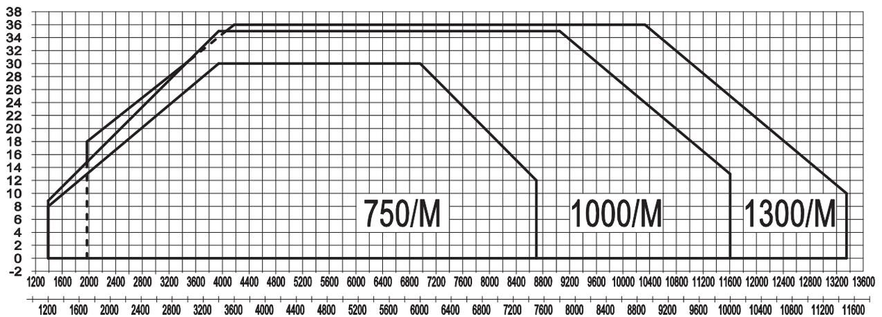
Fig. 2 X = Potencia térmica (kW - Mcal/h) Y = Presión en la cámara de combustión (mbar)
