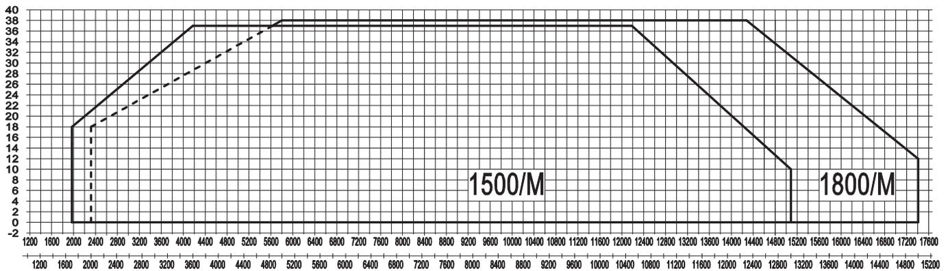
Fig. 3 X = Potencia térmica (kW - Mcal/h) Y = Presión en la cámara de combustión (mbar)
