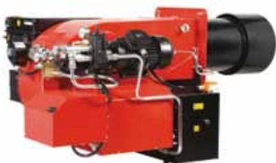
Bruciatori di nafta bistadio progressivi (hi-low flame) o modulanti (PID fully modulating) con l'aggiunta del sistema opzionale kit modulazione e sonda, ventilatore ad alta prevalenza, testa di combustione con regolazione ad alto rendimento ed elevata stabilità di fiamma, completo di elettroattuatore per l'apertura delle serrande aria comburente, adeguati per nafta fino a 20°E a 50°C e per nafta BTZ.
