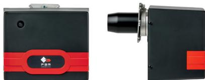
Bruciatori di gasolio monostadio, con scocca in alluminio, cofano di protezione con lastra fonoassorbente, testa di combustione con regolazione micrometrica ad alto rendimento ed elevata stabilità di fiamma.
