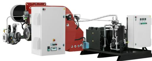
Bruciatori misti gas/olio combustibile (nafta) bistadio progressivo (hi-low flame) o modulanti (PID fully modulating) con l'aggiunta degli accessori opzionali kit di modulazione (digitale) e sonda (per controllo di temperatura o pressione). Adatti al funzionamento anche con combustibili BTZ (basso tenore di zolfo). Ventilatore ad alta prevalenza, testa di combustione con regolazione ad alto rendimento ed elevata stabilità di fiamma, completi di fiamma pilota di accensione gas.
