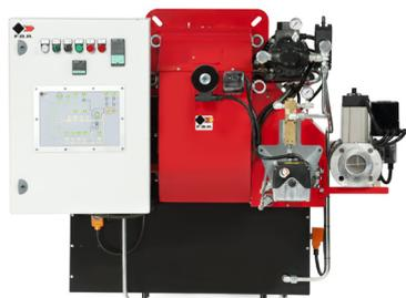
Bruciatori misti gas/olio combustibile (nafta) bistadio progressivo (hi-low flame) o modulanti (PID fully modulating) con l'aggiunta degli accessori opzionali kit di modulazione (digitale) e sonda (per controllo di temperatura o pressione). Adatti al funzionamento anche con combustibili BTZ (basso tenore di zolfo). Ventilatore ad alta prevalenza, testa di combustione con regolazione ad alto rendimento ed elevata stabilità di fiamma, completi di fiamma pilota di accensione gas.
