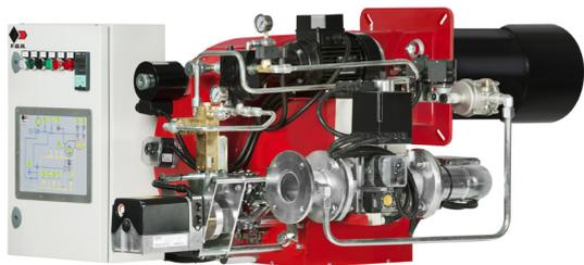
Bruciatori misti gas/gasolio bistadio progressivo (hi-low flame) o modulanti (PID fully modulating) con l'aggiunta degli accessori opzionali kit di modulazione (digitale) e sonda (per controllo di temperatura o pressione).
