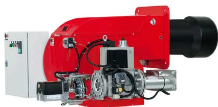
Brûleurs GAZ deux flammes progressifs (hi-low flame) ou modulants (PID fully modulating) avec l'addition du système optionnel kit modulation et sonde. Ventilateur à haute pressurisation, tête de combustion avec régulation à haut rendement et stabilité élevée de flamme.
