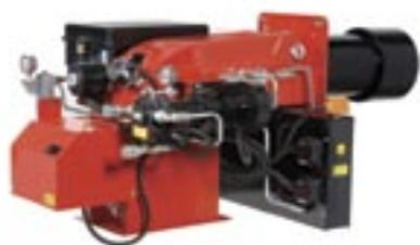
Brûleurs fioul lourd duobloc pour applications domestiques et industriels, 2 allures progressives (hi-low flame) ou modulantes (PID fully modulating) avec l'addition de système optionnel modulation et sonde (pour le contrôle de température ou pression). Ventilateur séparée que permet d'adapter sa puissance et sa pression à l'exact besoin du générateur.
