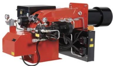
Testate per impianti civili ed industriali a olio combustibile (nafta) adatti al funzionamento anche con combustibili BTZ (basso tenore di zolfo), bistadio progressivo (hi-low flame) o modulanti (PID fully modulating) con l'aggiunta degli accessori opzionali kit di modulazione (digitale) e sonda (per controllo di temperatura o pressione). Ventilatore escluso da abbinare separatamente in base alle specifiche tecniche dell'impianto.
