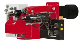
Brûleurs fioul lourd duobloc pour applications domestiques et industriels, 2 allures progressives (hi-low flame) ou modulantes (PID fully modulating) avec l'addition de système optionnel modulation et sonde (pour le contrôle de température ou pression).
